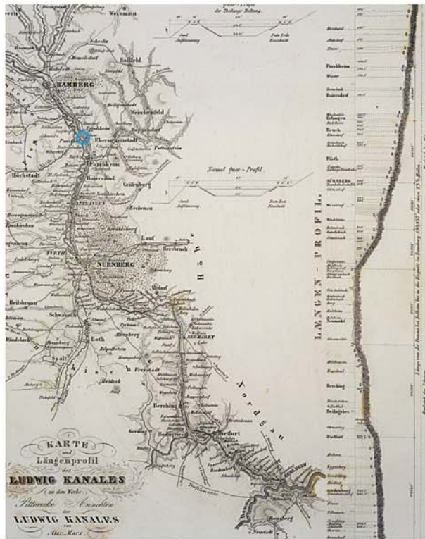
Der Ludwig-Donau-Main-Kanal von 1846 überwand bei Neumarkt / Opf. die europäische Wasserscheide.
