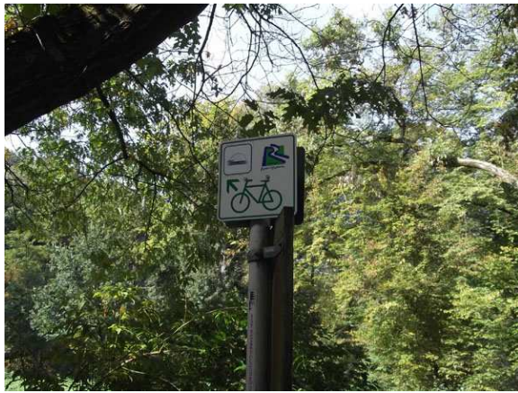
Bild links: nicht-FGSCV-konformer Zwischenwegweiser mit zwei Routensymbolen
